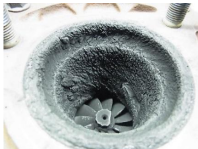
排気出口カーボン蓄積
