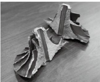
エンジンのオーバーランによって排気ガスの流量が増え、その結果、ターボまでオーバーランする可能性も、ターボがオーバーランすると高サイクル疲労でバーストする危険がある
